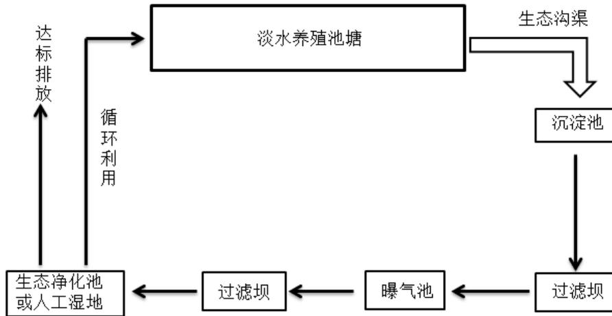
图 E.1 尾水处理工艺流程图
