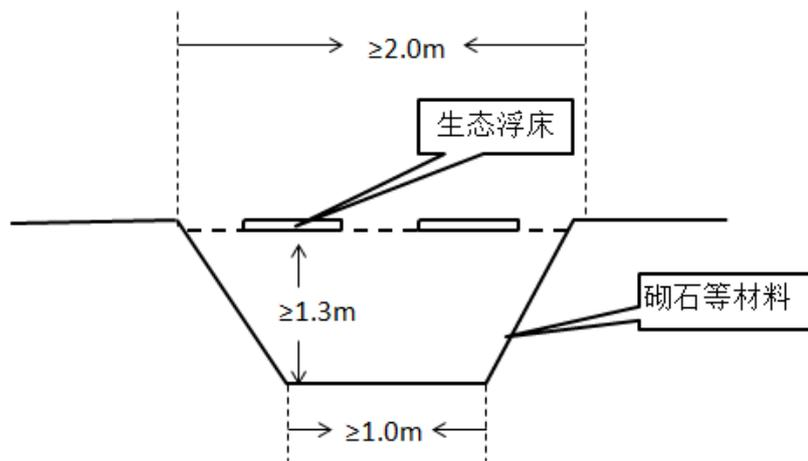
图A.1 生态沟渠剖面图
