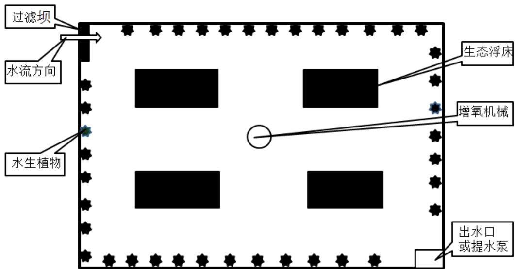
图 D.1 生态净化池布局图
