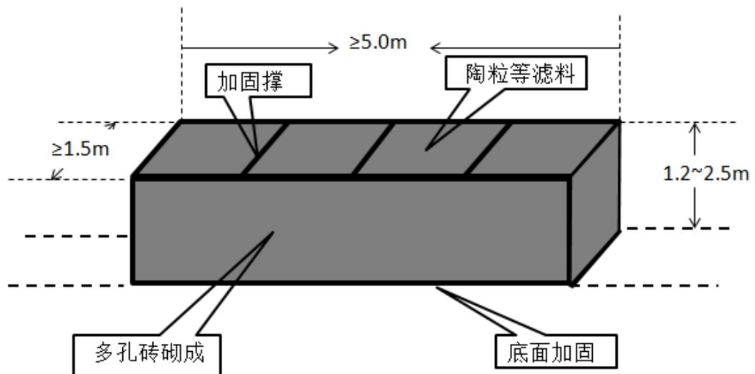
图B.1 过滤坝结构图
