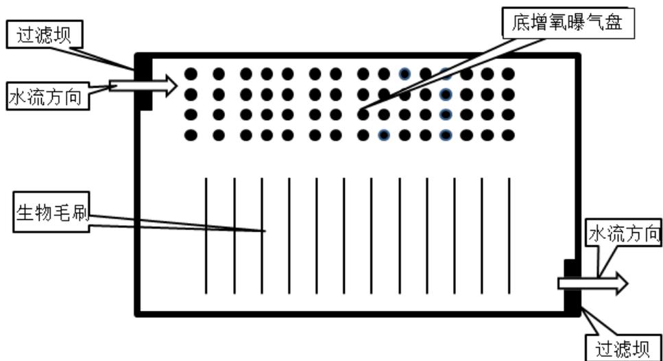
图 C.1 曝气池布局图
